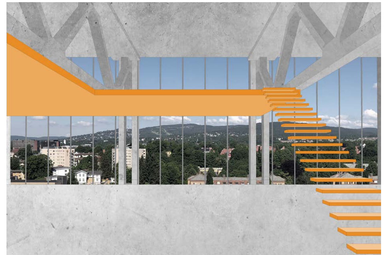
Over: Ill. 8. Tekniske installasjoner i midtre del av teknisk etasje gjør mesaniner langs fasaden mulig. Under: Ill.9. Mesanin og dobbel takhøyde.
